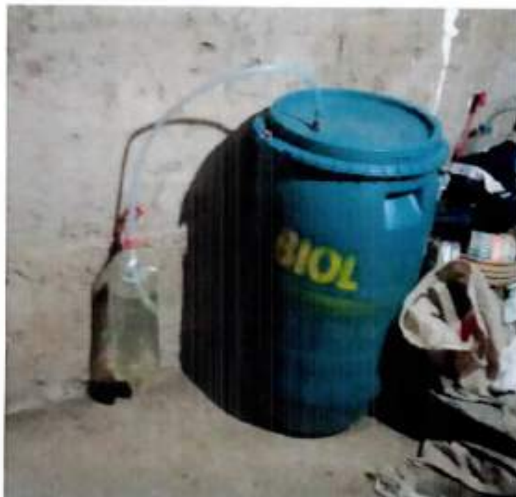
Módulo de Biol en proceso de fermentación
