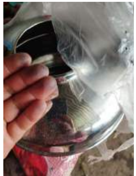
Anexo 02 Tetera entregada a hogar usuario con desprendimiento de partículas color plomo
